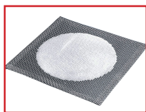
Tela de asbesto
