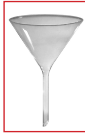
Embudo de filtración
