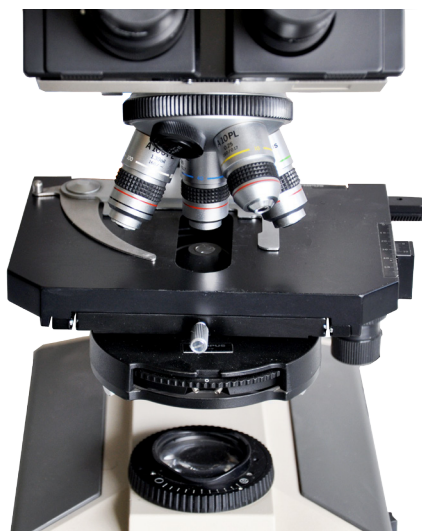
Figura 2. Condensador de fases, diferencia básica con el microscopio de campo claro.
