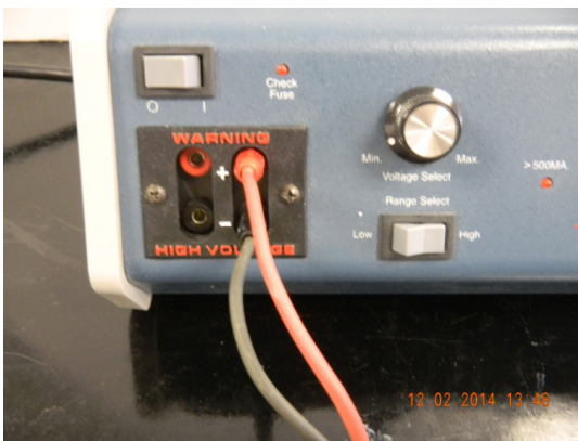
Figura 19. Electrodo de la cámara conectados a la fuente de poder
