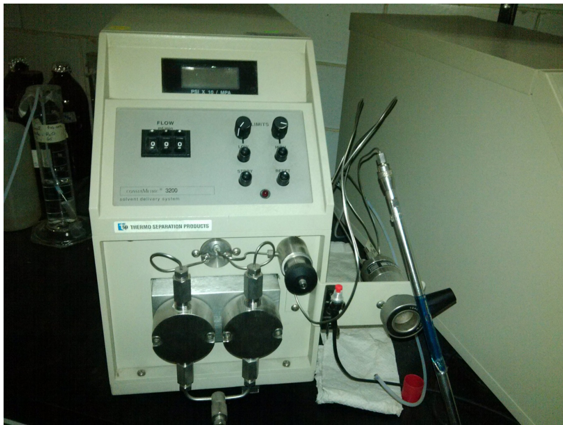
Figura 14. Módulo de bomba binaria, para separaciones isocráticas.
